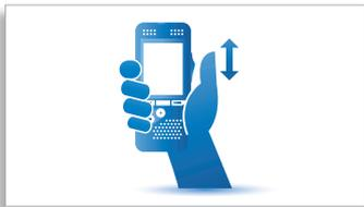
L'interrupteur à curseur très réactif et ergonomique est conçu pour pouvoir activer d'une seule main toutes les fonctions d'enregistrement et de lecture et offre des capacités d'édition des fichiers simples et rapides (insertion, remplacement et ajout). Il fonctionne avec un signal de capteur optique pour éviter toute usure prématurée et augmenter sa durée de vie.
