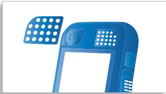
La technologie de pointe 3D Mic utilise deux microphones intégrés pour fournir une excellente qualité d'enregistrement : un microphone omnidirectionnel doté d'un capteur de son à 360 degrés permettant d'enregistrer les données provenant de plusieurs sources sonores (réunions, par exemple), et un microphone directionnel optimisé pour l'enregistrement vocal et pour offrir des fonctions de reconnaissance vocale très fiables.
